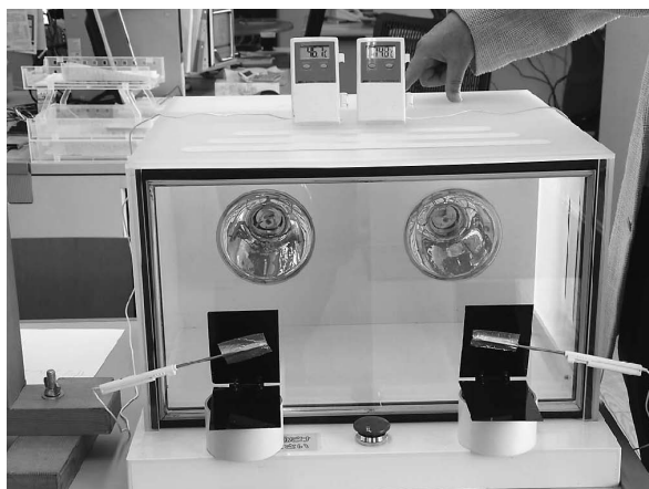
赤外線ライトによる照射実験 左：46.7℃（施工ガラス）、右：74.8℃（未施工ガラス）
