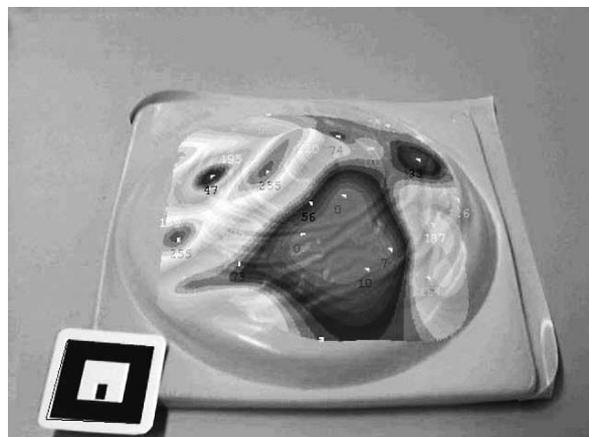
図3：乳がんの模型と触覚センサー、位置情報のためのマーカー（左）
